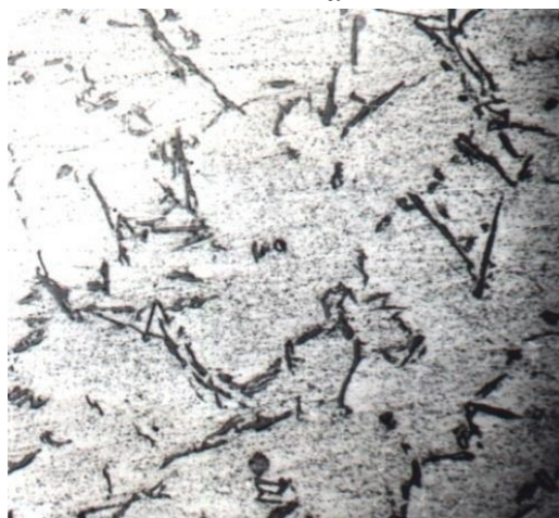
Рисунок 3.12 – Схема нанесения отпечатков (а - \times 50 ), мозаика микроструктур зоны растворения при 10-ти минутной выдержке (б - \times 200 ) и микроструктура междендритного пространства (в - \times 500 )
